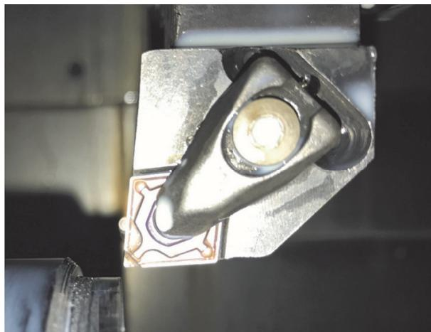
**Рис. 6.** Обработка заготовки на токарно-карусельном станке с ЧПУ 1А512Ф3
