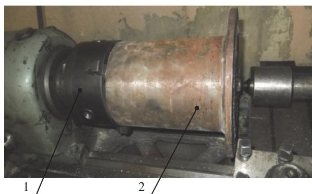
**Рис. 5.** Оснастка для упрочнения конических шестерён на токарном станке путем динамического наклёпа поверхностей зубьев стальными шариками и порошком фторированного графита:
