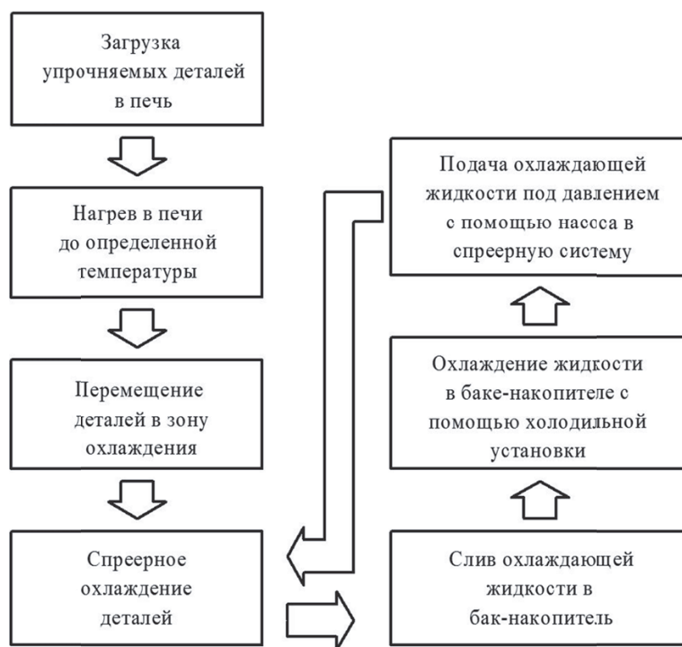
Рис. 1. Блок-схема технологического процесса термопластического упрочнения детали
