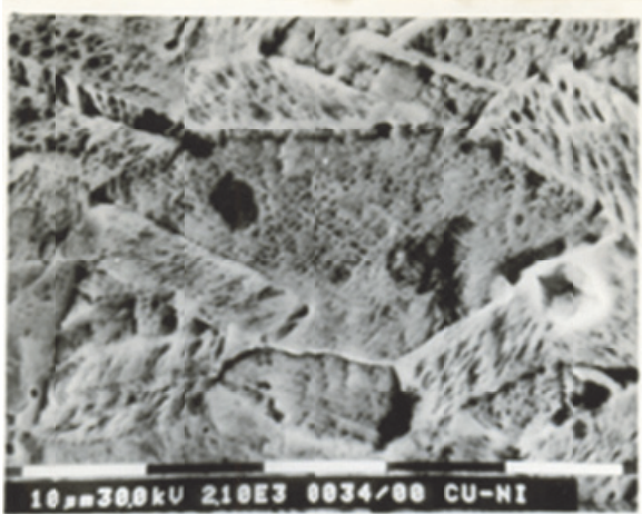
Рис. 1. Электронная растровая микрофотография поверхности никеля с нанесенным слоем меди после короткоимпульсного лазерного воздействия. Увеличение 2000 x
