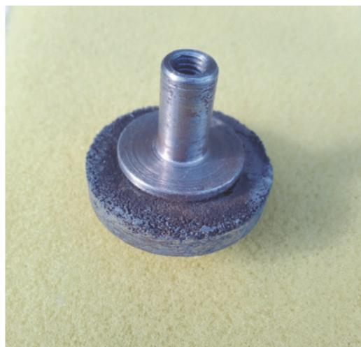
Рис. 5. Шлифовальный круг из  $Ti_3SiC_2$  на оправке
