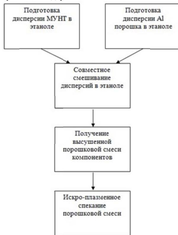
**Рис. 2.** Схема лабораторной технологии получения металлокомпозита с МУНТ
