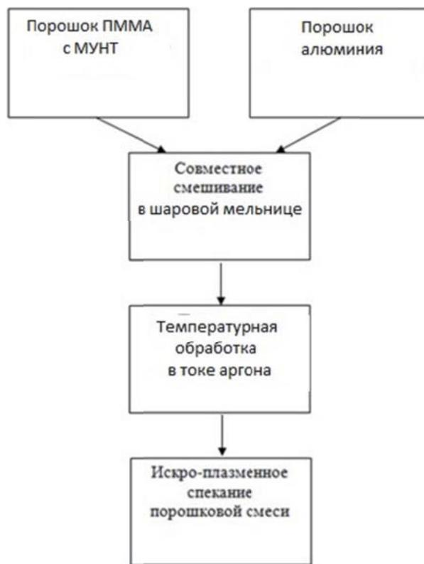
Рис. 3. Схема введения МУНТ из полимерной матрицы в металлическую
