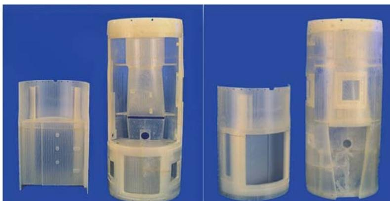
**Рис.5.** Использование технологии SLA для точного изготовления крупногабаритных изделий
