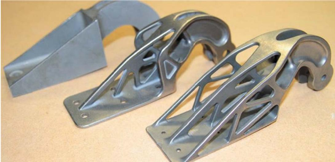
Рис. 11. Изготовление облегченного кронштейна из титанового сплава с использованием аддитивных технологий
