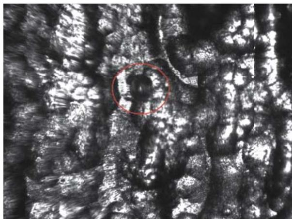
**Рис. 11.** Изображение проявившейся поры при травлении
