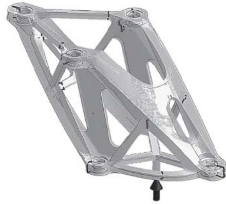
Рис. 13. Линии спая в кронштейне после корректировки
