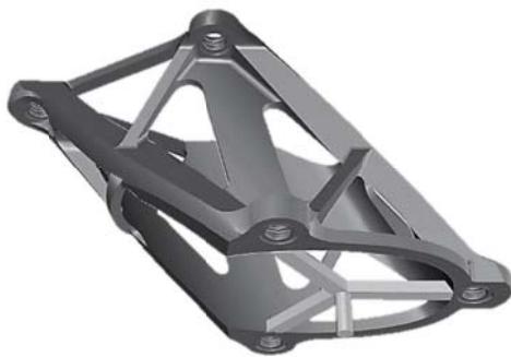
Рис. 12. Перестроенная литниковая система в кронштейне
