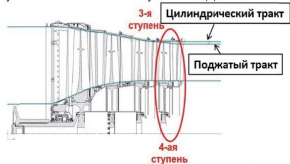
**Рис. 9.** Фрагмент чертежа модифицированного КНД с добавлением 4-ой ступени на базе 3-ей ступени КНД
