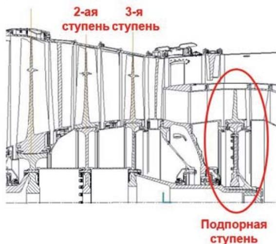
Рис. 6. Фрагмент чертежа модифицированного КНД с добавлением подпорной ступени на базе 3-ей ступени КНД
