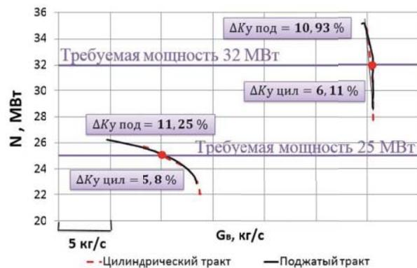
**Рис. 10.** Мощностная характеристика КНД с добавлением 4-ой ступени на базе 3-ей ступени КНД
