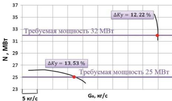
Рис. 14. Мощностная характеристика КНД с до-бавлением спрямляющего аппарата
