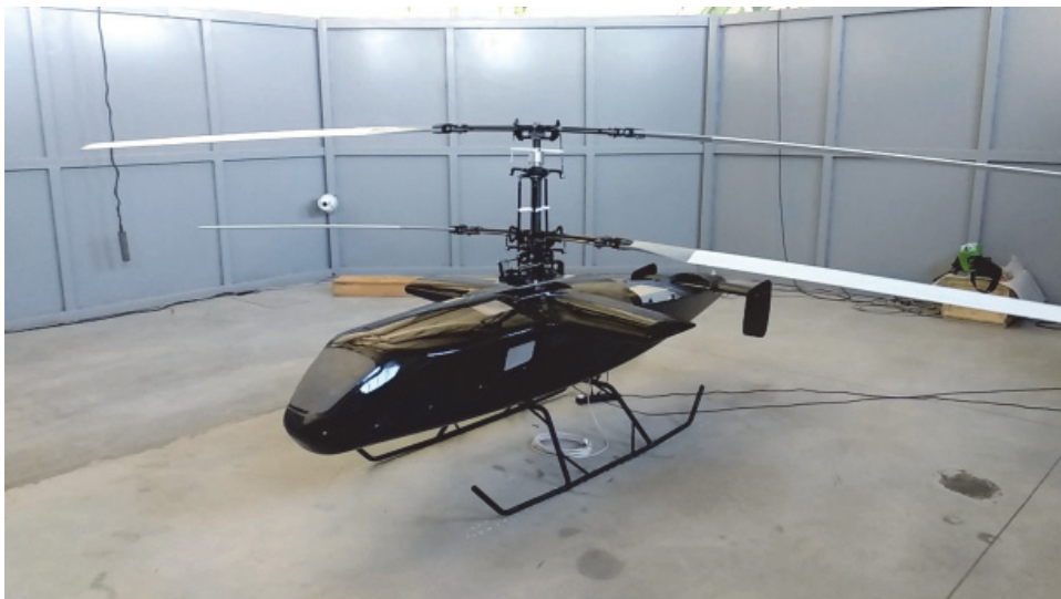
Рис. 1. Беспилотный летательный аппарат вертолетного типа взлетной массой до 500 кг
