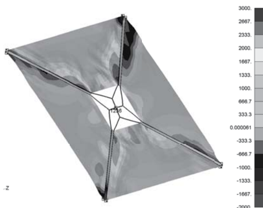
Рис. 11. Нормальные напряжения вдоль оси X [Па] при выполнении программного разворота с угловой скоростью \omega_2 = 311 град/сут
