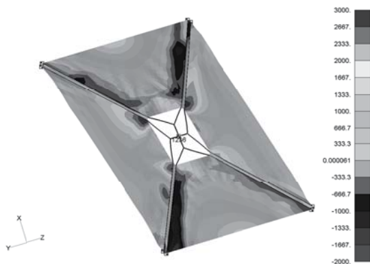
Рис. 12. Нормальные напряжения вдоль оси Y [Па] при выполнении программного разворота с угловой скоростью \omega_2 = 311 град/сут
