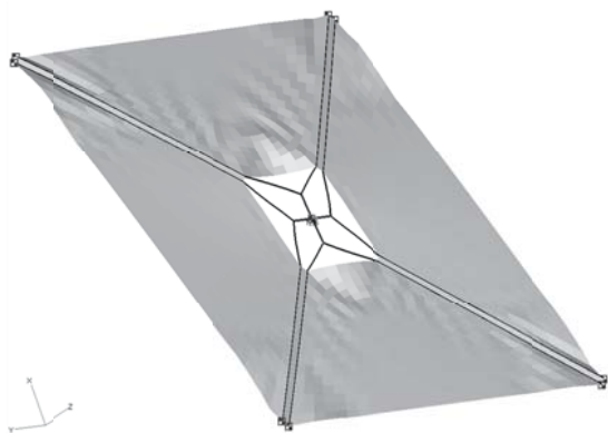
Рис. 10. Деформации КАСП при выполнении программного разворота с угловой скоростью \omega_2 = 311 град/сут
