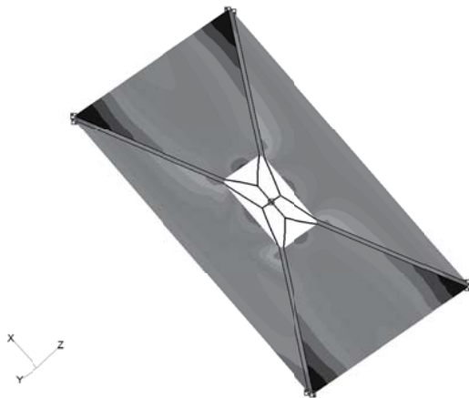
Рис. 6. Касательные напряжения перпендикулярные осям X и Y [Па] при раскрытии
