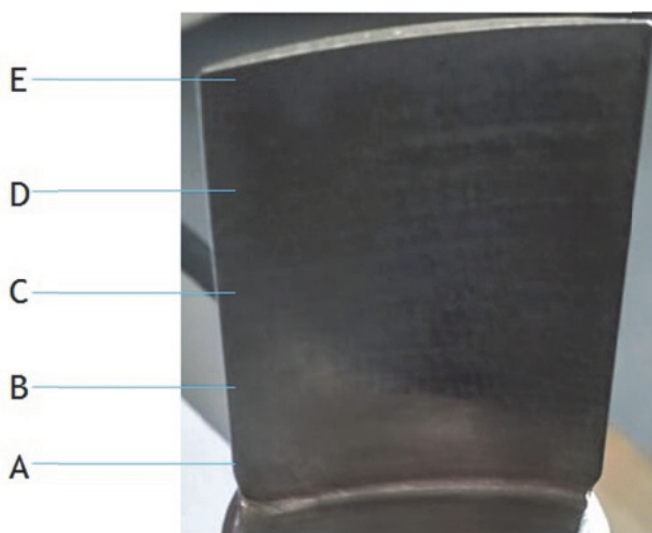
Рис. 4. Изготовленное перо лопатки компрессора ГТД с отмеченными измеряемыми сечениями
