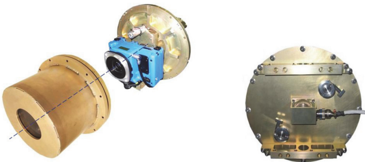
Рис. 4. Монтаж фотограмметрического устройства внутри гермоконтейнера
