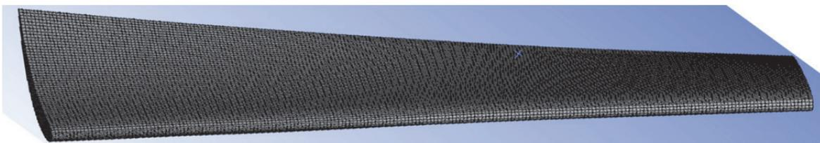
Рис. 2. Конечно-элементная модель газодинамической части лопатки компрессора ГТД семейства «НК», созданная в программном комплексе *ANSYS*
