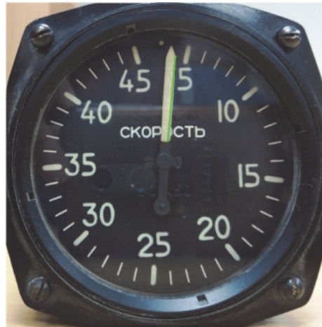
Рис. 7 Результат обнаружения стрелки
