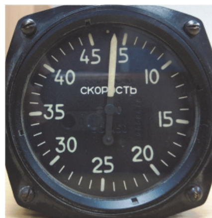
Рис. 1. Указатель скорости – 450 (УС-450)
