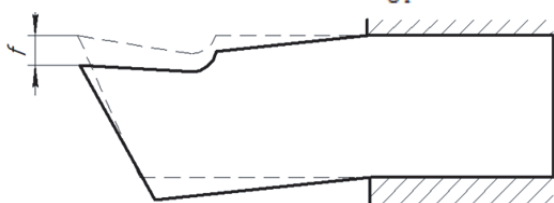
Рис. 2. Схема для расчёта прогиба резца при использовании плоской модели
