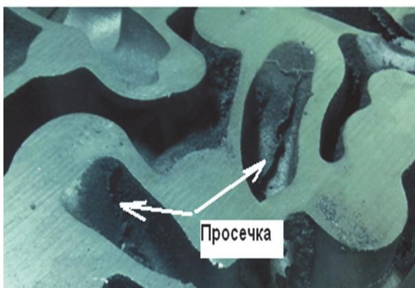
**Рис. 4.** Разрез опытной отливки «Головка цилиндров»**Выводы:**
