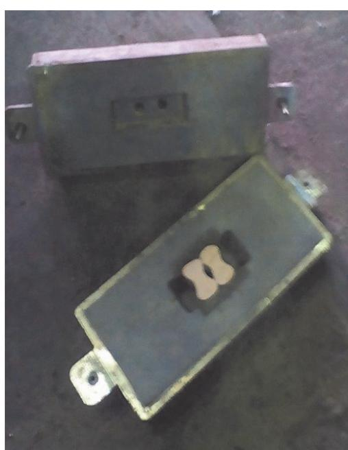
**Рис. 2.** Форма с опытными стержнями «восьмерка» для заливки образца
