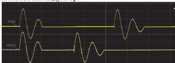
**Рис. 12.** Сравнительные осциллограммы тока в режиме асинхронного разряда двух накопителей с разной задержкой: (масштаб развертки – 100 мкс/дел.; - верхний луч, асинхронный разряд с задержкой 440 мксек; - нижний луч, разряд двух накопителей энергии, с задержкой 250 мксек).
