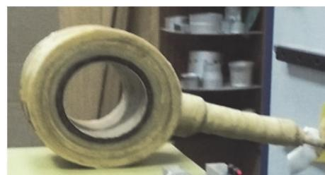
**Рис. 7.** Цилиндрический индуктор
