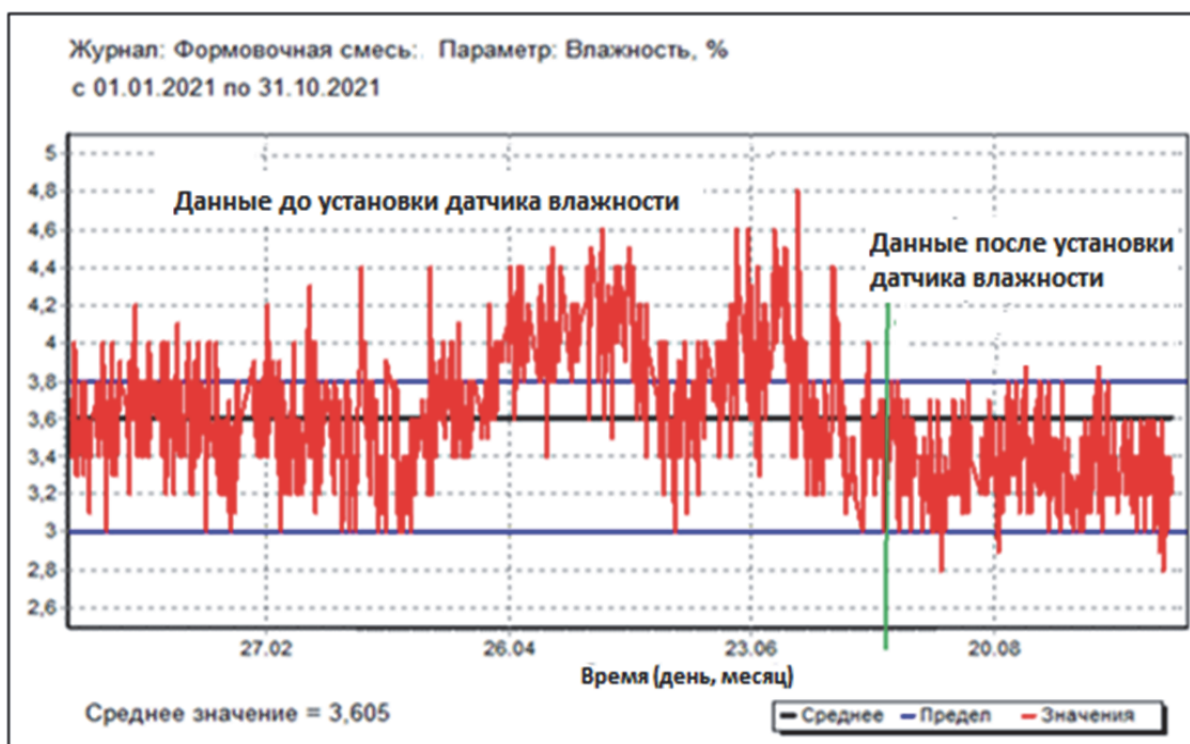
Рис. 4. График значений параметра «влажность» формовочной смеси автоматической формовочной линии
