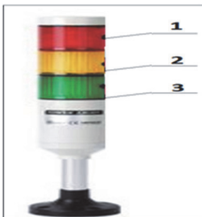
Рис. 3. Светофор системы контроля влажности формовочной смеси автоматической формовочной линии: 1 – красный светодиод светофора; 2 – желтый светодиод светофора; 3 – зеленый светодиод светофора
