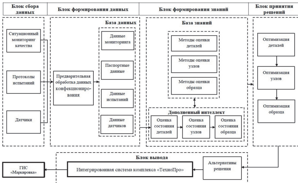
Рис. 4. Архитектура системы контроля и оценки качества кожевенно-обувного производства на основе дополненного интеллекта
