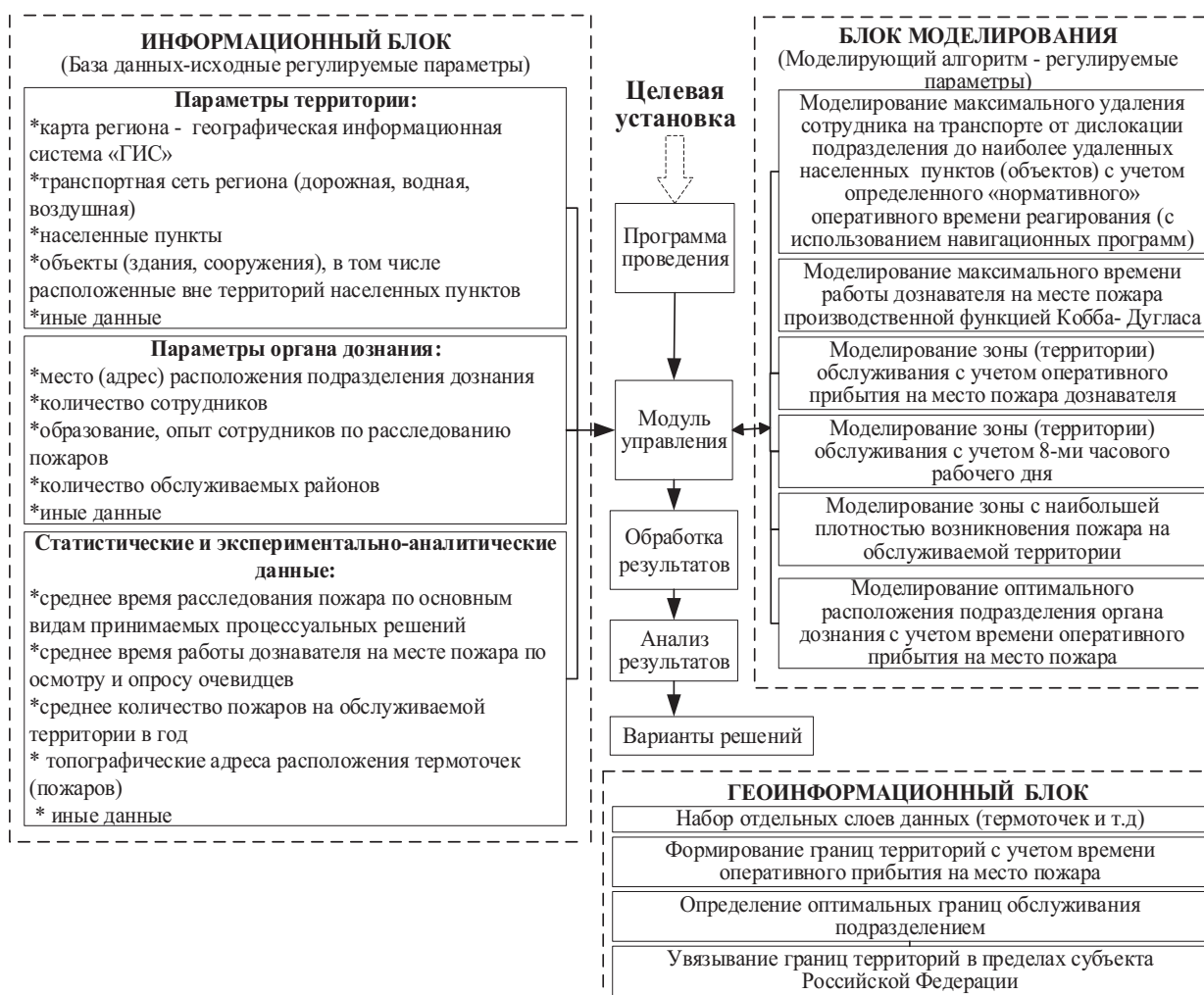
Рисунок 10 – Общая структура определения оптимальных границ обслуживания методом геоинформационного моделирования
