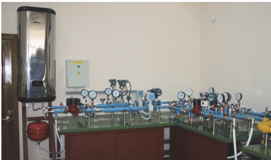
Рис. 1 – Лабораторный стенд учета тепла
