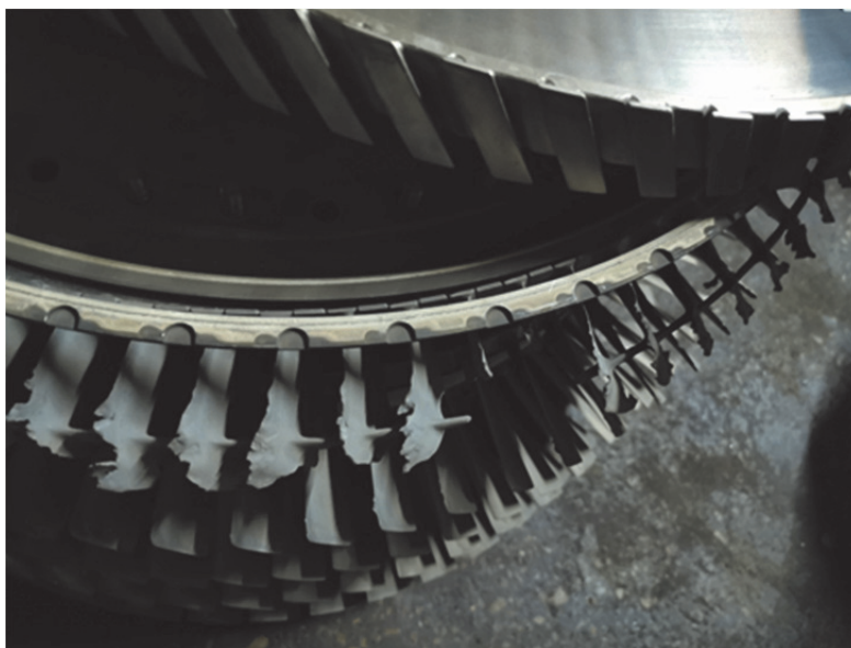
Рис. 2. Не прошедшее испытания рабочее колесо
