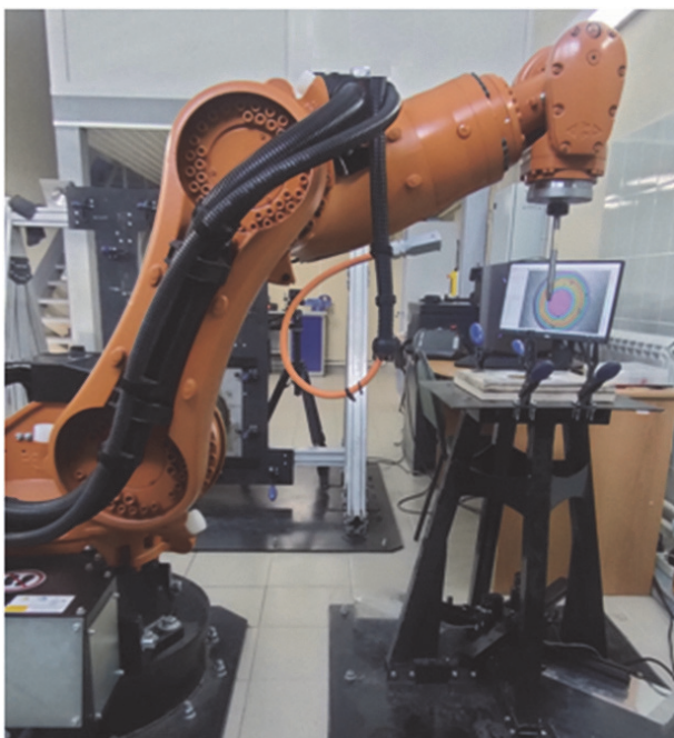
Рисунок 1 – Стенд инкрементального формообразования на базе промышленного робота-манипулятора KUKA KR 160 R 1570 nano
