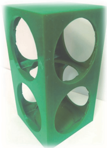
Рисунок 9 – Оработка внутреннего заполнения стенок корпуса МКА НК материалом - 100%
