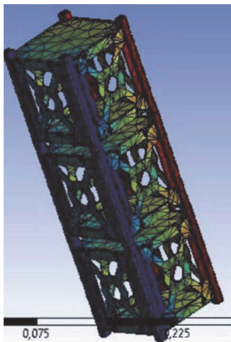
Рисунок 4 – Расчет прочности корпуса МКА НК в САЕ модуле
