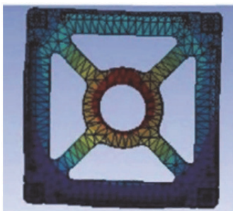
Рисунок 4 – Расчет прочности корпуса МКА НК в САЕ модуле
