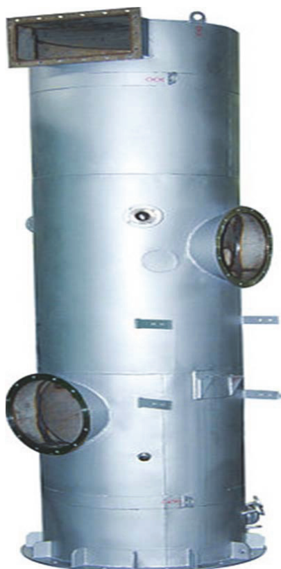
Рис. 1. Насадочный плёночный абсорбер.
