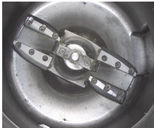
Рис. 5. Износ подвижных ножей установки Newster – 5
