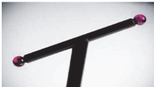
Рис. 5. Вид меры для поверки систем General Electric : а) – с 2 сферами; б) – с 4 рубиновыми сферам
