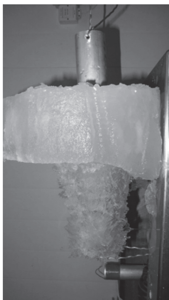
Рис. 2. Пример ледового воротника (слева – физический эксперимент, справа – схема формы ледового воротника и характерные размеры: h , L , b , \alpha )
