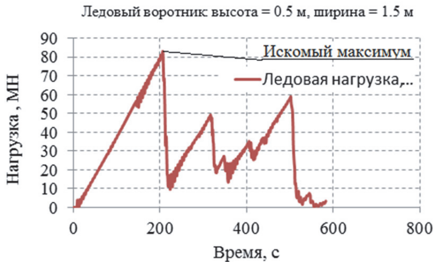
Рис. 4. Зависимость ледовой нагрузки от времени в ходе моделирования; показан максимум, используемый для дальнейших оценок
