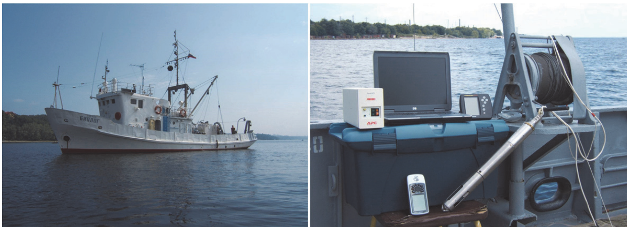
Рис. 2. Научное судно «Биолог» (слева) и система контроля качества воды «Хитон» для диагностики пространственных неоднородностей (справа)
