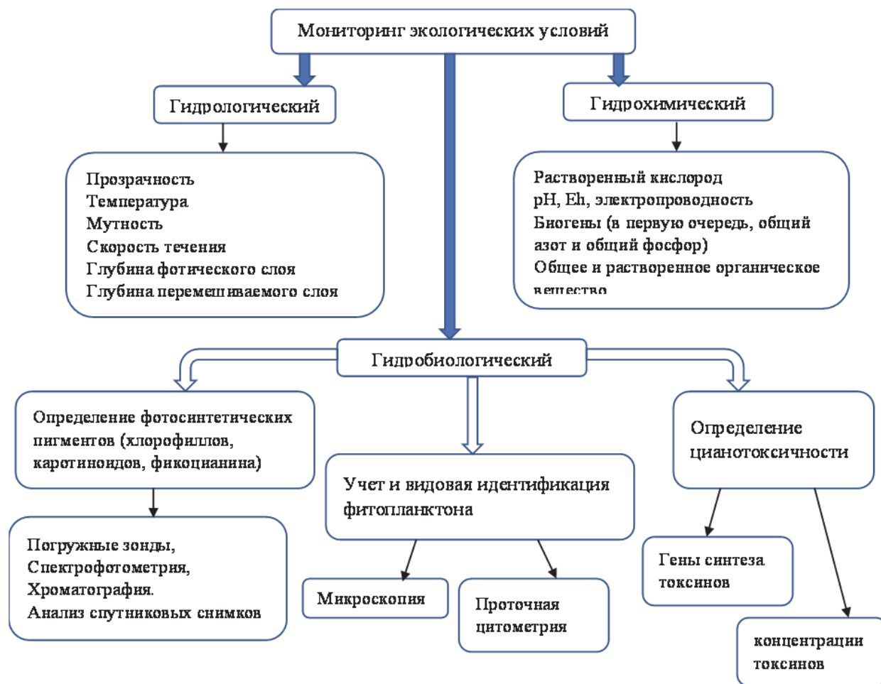
Рис. Блок-схема экологического мониторинга пресных водоемов, в которых наблюдаются опасные цианобактериальные цветения
