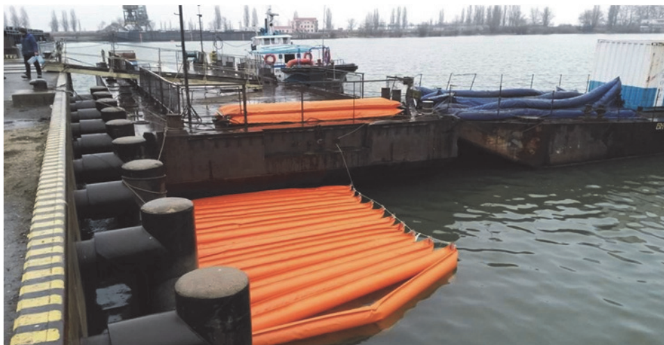
Рисунок 2 – Боны, наполненные сорбционным материалом из хитозана и пенополиуретана
