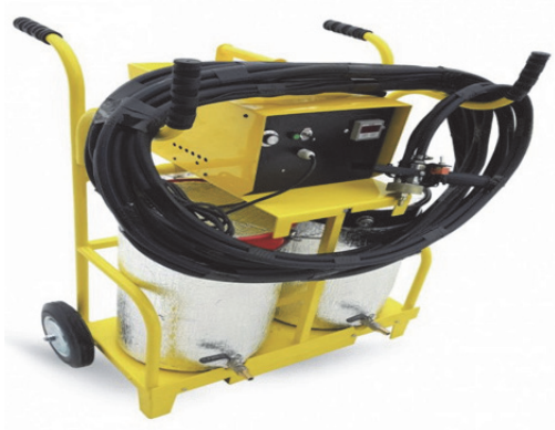
Рисунок 4 – Переносная установка производства сорбционного материала
