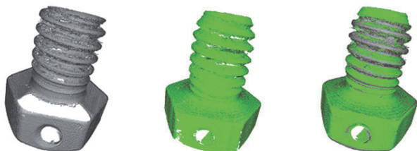
Рис. 3. Контроль геометрических параметров изделия с помощью облака точек
