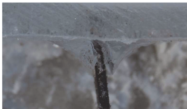
Рис. 1. Ледовый воротник на наклонной пластине
