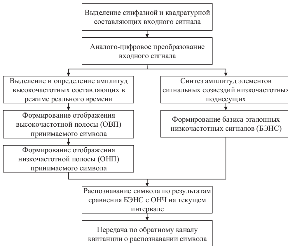
Рисунок 1 – Принцип потокового распознавания многочастотных символов с квитированием
