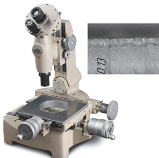
Рис. 4. Малый инструментальный микроскоп и пример измерения износа по задней поверхности
