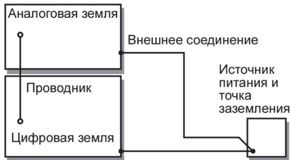
Рисунок 10 – Контур возвратных токов при зонировании аналоговой и цифровой схем
