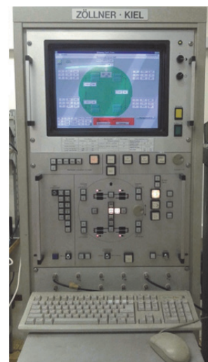
Рисунок 14 – Динамометрический поворотный роликовый стенд ф.ZOLLNER а) стенд; б) панель управления стендом
