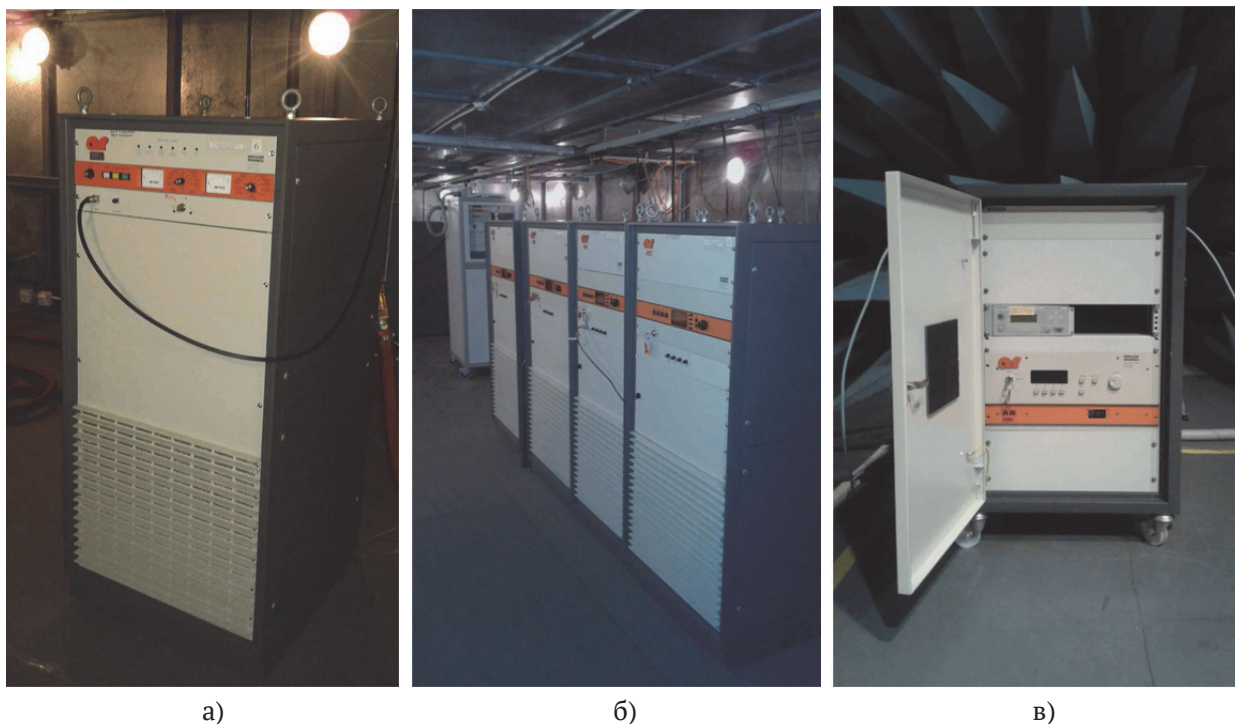
Рисунок 11 – Применяемые усилители мощности: а) AR 10000 L; б) AR 3000 W; в) AR 500 TG 2
