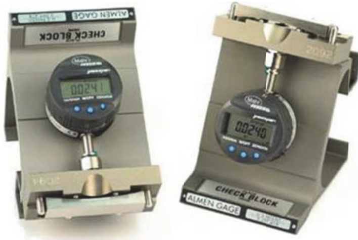
Рис. 3. Современные приборы TSP-3 для измерения деформации образца-свидетеля согласно стандарту SAE J442
