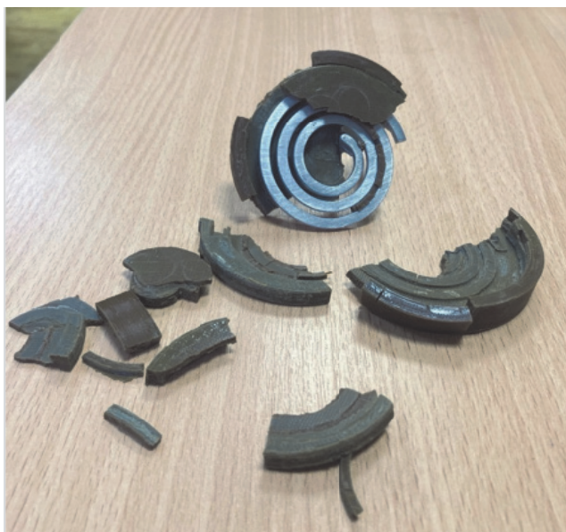
Рисунок 12 - Разрушение индуктора в результате испытания его на рабочем режиме в 7 кВ
