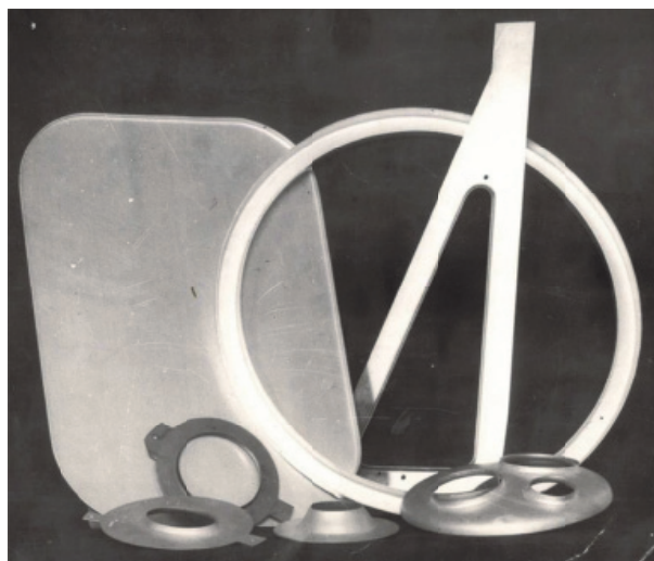
Рисунок 2 - Примеры деталей, полученных с помощью ИМП из листовых заготовок
