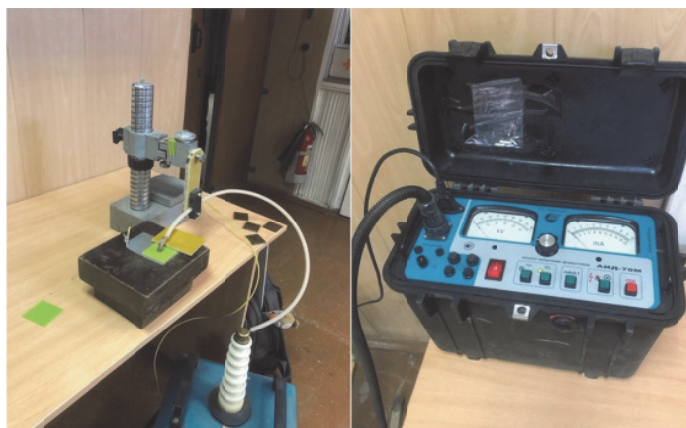
Рисунок 9 - Испытательный стенд «Аппарат испытания диэлектриков АИД-70М» для оценки пробивного напряжения
