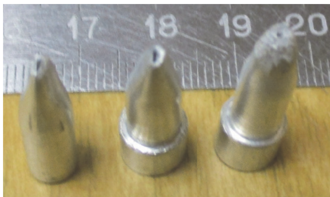
Рис. 4. Не замыкание внутренней полости обжатых образцов после их осевого разрушения при магнитно-импульсном обжатии в условиях просачивания и кумуляции магнитного поля
