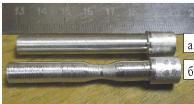
Рис. 5. Фото образцов длиной 60 мм: а) исходный образец; б) образец, обжатый до смыкания внутреннего канала ( W = 21,4 кДж)
