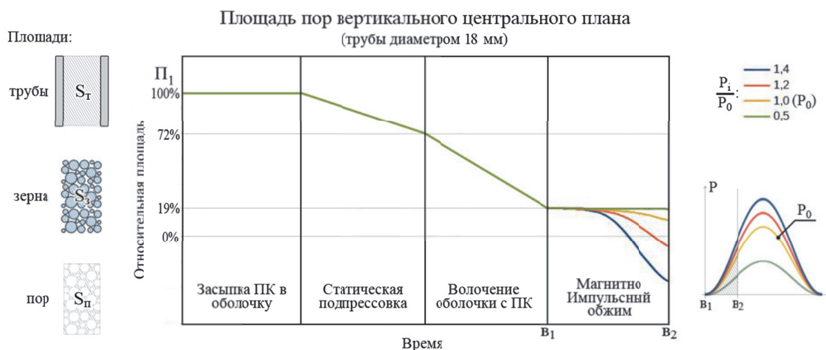
Рисунок 8. Изменение плотности уплотнения ПК на всех этапах процесса уплотнения по схеме I
