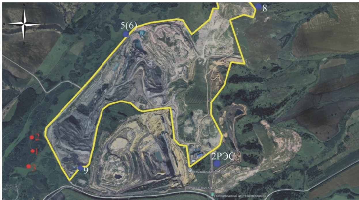
Рис. 1. Схема земельного отвода разреза Пермяковский: 9, 5(6), 8, 2РЭС – гидронаблюдательные скважины, 1 – сброс № 1 в реку Иню, 2 – точка отбора проб воды (500 м выше сброса), 3 – точка отбора проб воды (500 м ниже сброса)
