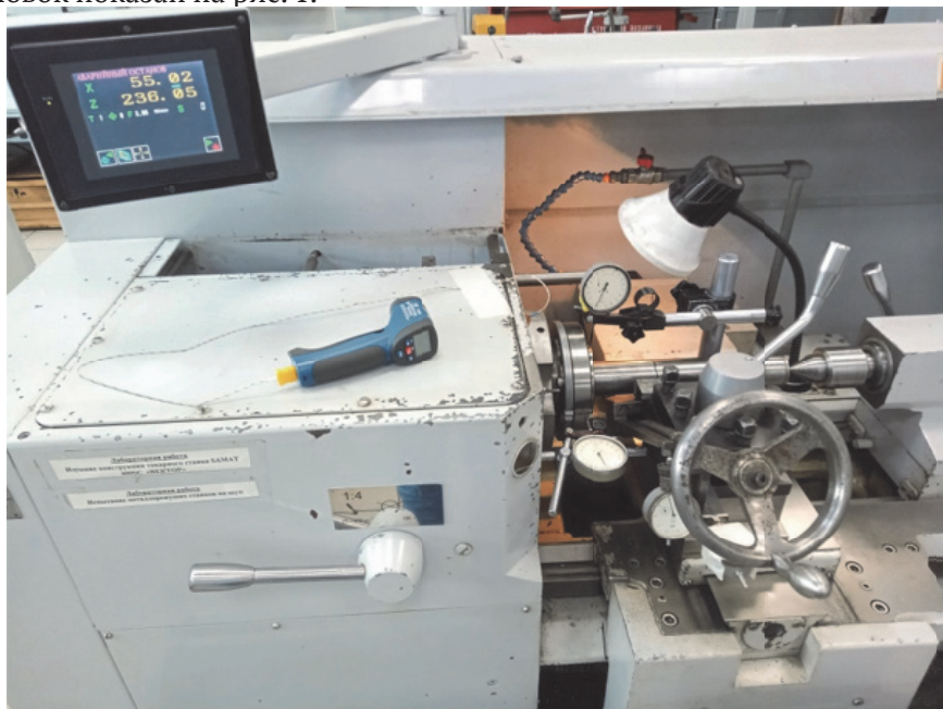
Рис. 1. Экспериментальная установка на базе станка 400ХС «Вектор»
