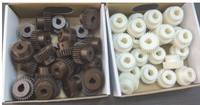
Рисунок 3 – Экспериментальные зубчатые колеса: PLA CF (слева), PLA + (справа)
