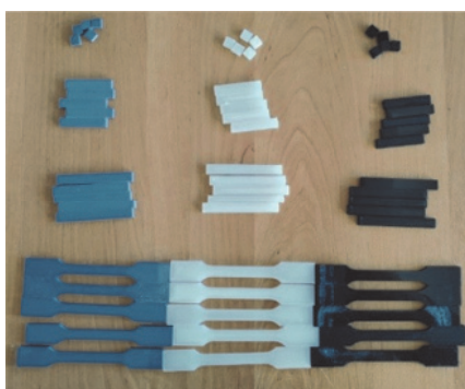
Рисунок 1 – Образцы участвующие в испытании: ABS – черный; PLA – серый; Нейлон – белый.
