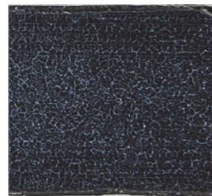
Рисунок 7 – Внешний вид ТРЕЕ после выдержки в растворе кислоты
